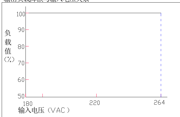
输出负载降额与输入电压关系
