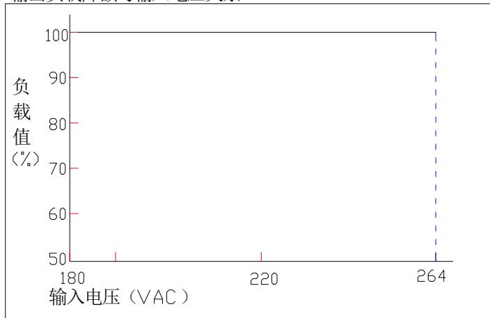
输出负载降额与输入电压关系
